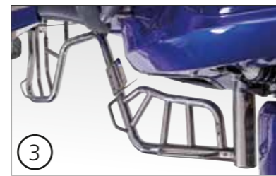
Beinschutz- und Gepäckaufnahmebügel VA Ø 60 mm
